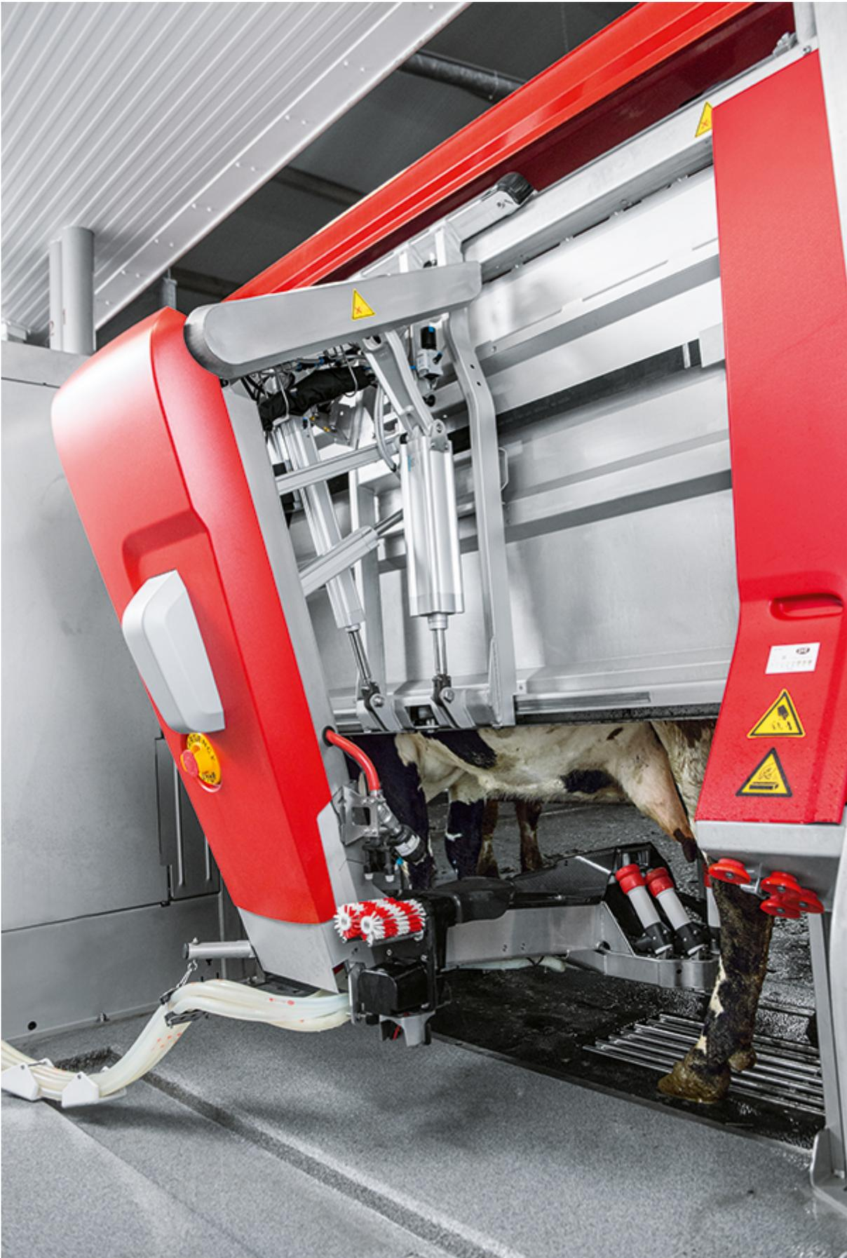
Die Bewegungen des Roboterarms mit elektrischen Achsen von Festo und entsprechender Software sind sanfter; zudem ist der Prozess energieeffizienter und schneller.
