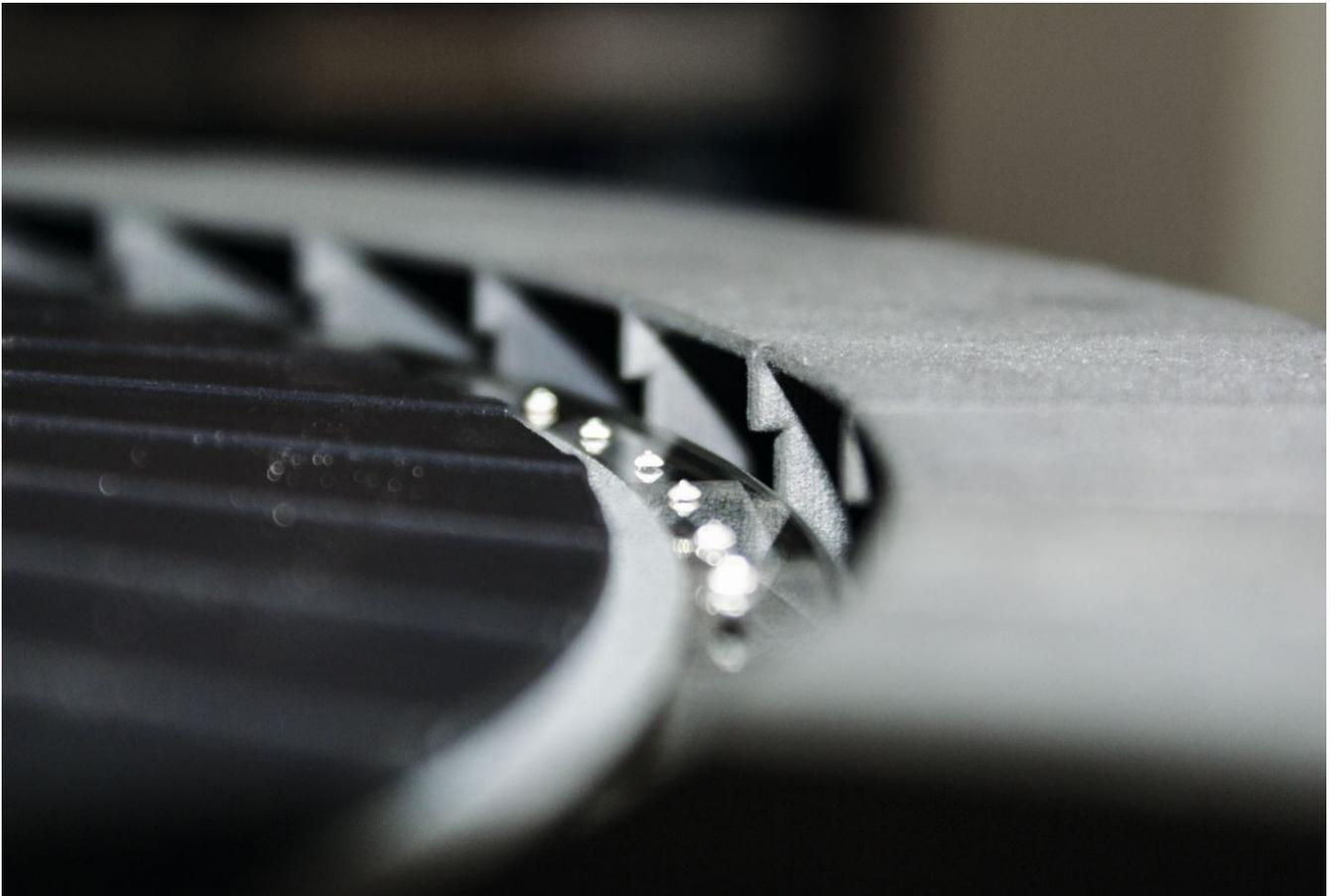
Die Diamanten bewegen sich auf der rotierenden Glasscheibe zwischen Düsen und Sortierfächern. Sobald ein Stein den seiner Größe entsprechenden Auswurfpunkt erreicht hat, schiebt ihn ein Druckluftimpuls in den entsprechenden Behälter.
