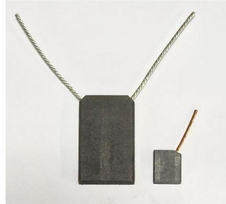
Bei der Stampfstation wird die Kupferlitze im Einstampfverfahren in die Kohlebürsten eingebracht. Unser [MHE4-MS1H Schnellschaltventil](#) sorgt für die kurzen Zykluszeiten. Unterschiedlichste Kohlebürsten-Varianten lassen sich mit kürzesten Rüstzeiten auf der BAZ 200-6 NC realisieren.
