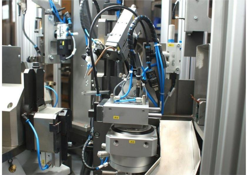
Mittels 5-Achsbetrieb macht das Fräswerkzeug die Bearbeitung in unterschiedlichsten Winkeln möglich. Vor dem Entladen wird der Stampfkontakt abgelackt und das fertige Teil in eine Schiene geschoben. Ein [VN Vakkumventil](#) mit Unterdruckschalter ermöglicht es, unterschiedlichste Varianten einfach zu greifen.
