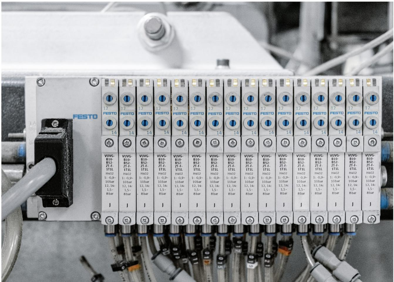
[DSNU-Rundzylinder](#) drücken die Korke zusammen – angesteuert werden die Zylinder von unserer [Ventilinsel VTUG](#).
