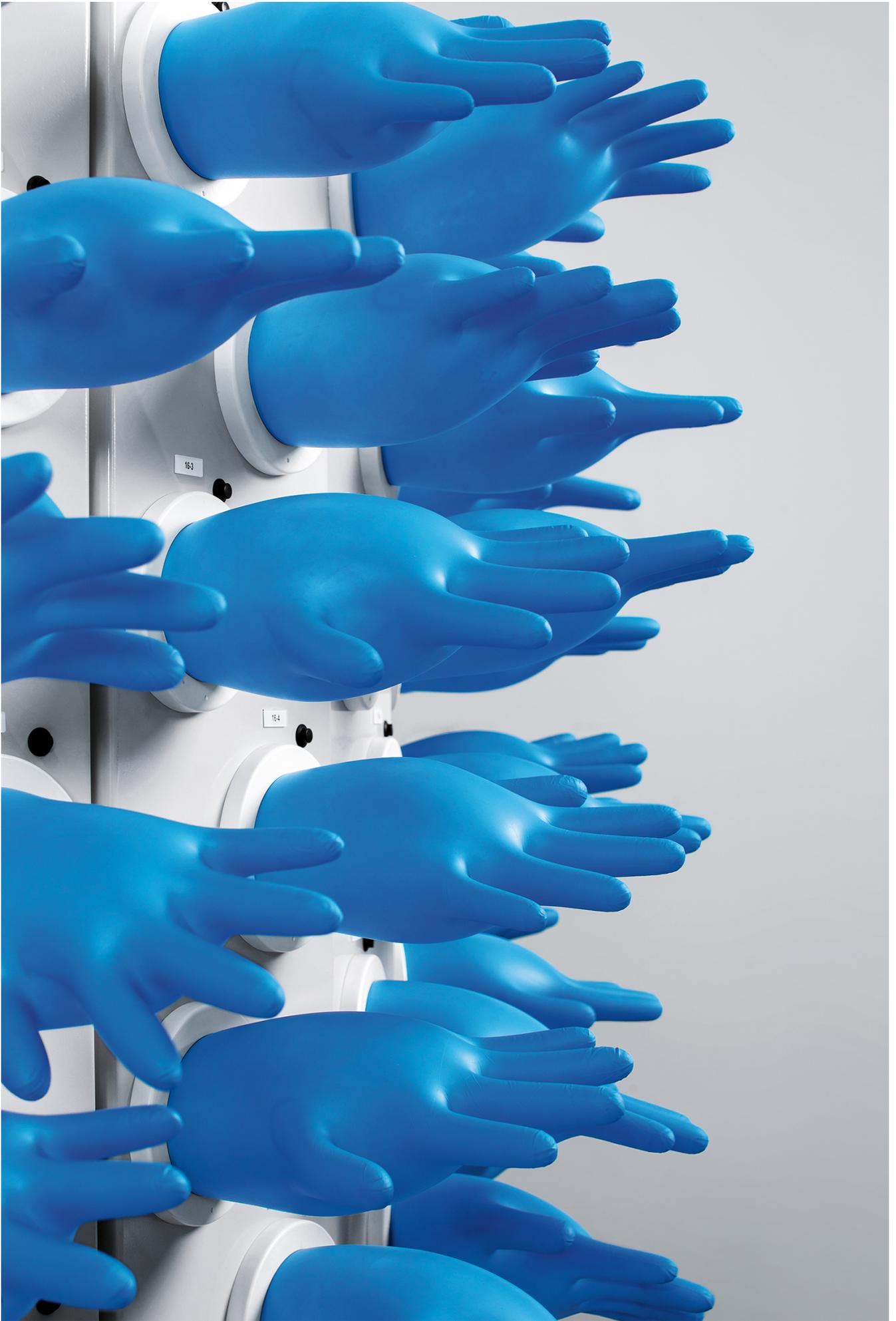
Qualitätssicherung: 120 Prüfdorne testen die Einmalhandschuhe aus Naturkautschuk und Nitril. (Bild: AFA Technologies)
