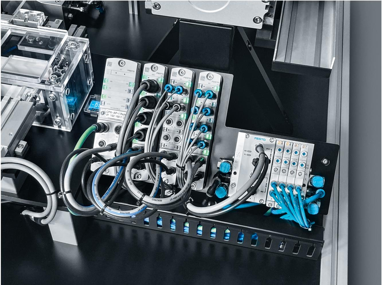
Unser Remote IO-System CPX-AP-I integriert alle IOs und IO-Link Teilnehmer nahtlos in das Kommunikationsnetzwerk der Anlage.
