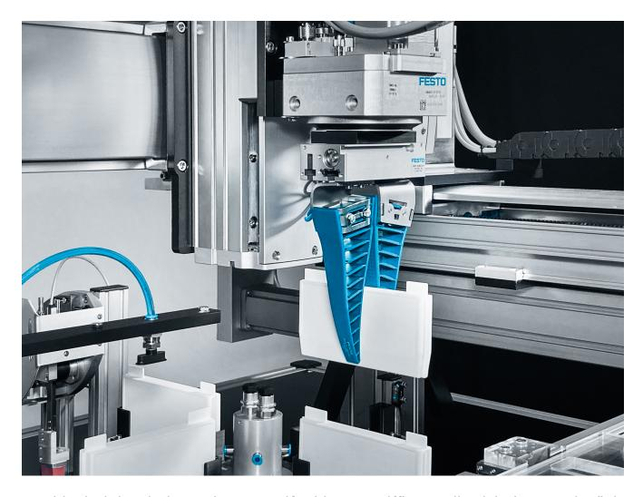
Der bionisch inspierierte FinRay-Greifer bietet Greiffinger, die sich dem Werkstück anpassen. Das erlaubt das sichere und taktile Greifen von plastisch verformbaren Werkstücken wie z.B. Pouchzellen.
