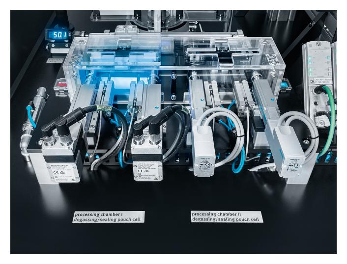
Kern der Anwendung ist die Prozesskammer. Pneumatische und elektrische Aktoren bewegen hohle Lanzen, die die Batteriezellen anstechen.
