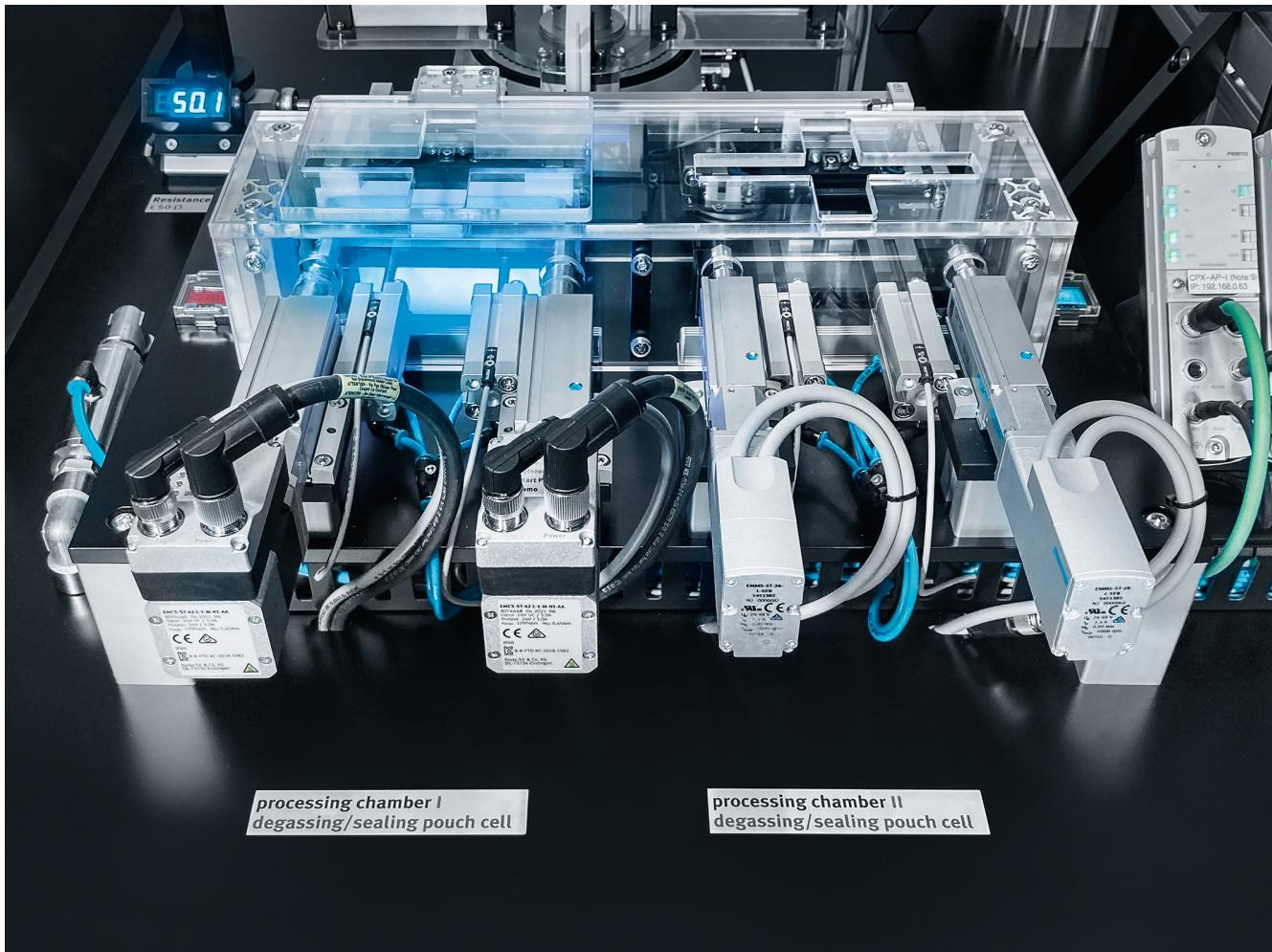
Kern der Anwendung ist die Prozesskammer. Pneumatische und elektrische Aktoren bewegen hohle Lanzen, die die Batteriezellen anstechen.
