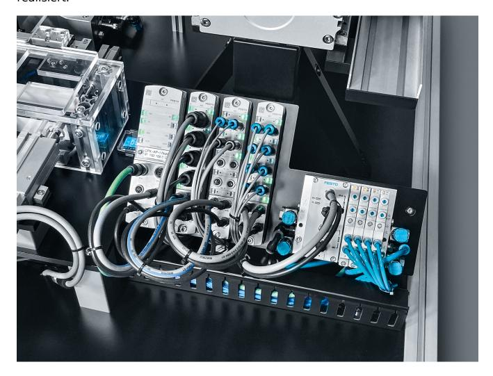
Unser Remote IO-System CPX-AP-I integriert alle IOs und IO-Link Teilnehmer nahtlos in das Kommunikationsnetzwerk der Anlage.
