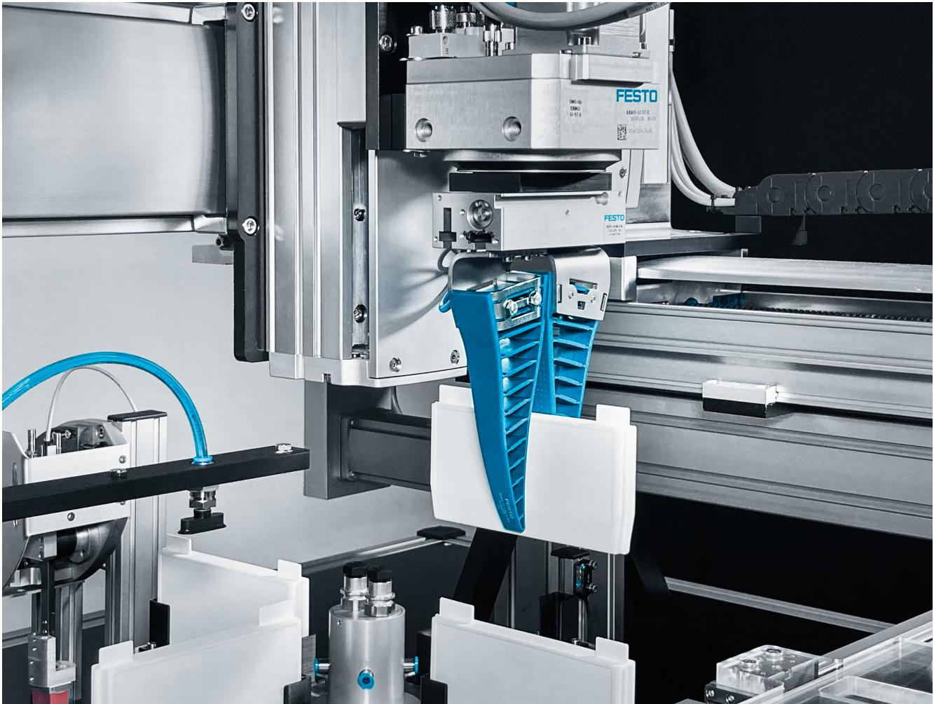
Der bionisch inspirierte FinRay-Greifer bietet Greiffinger, die sich dem Werkstück anpassen. Das erlaubt das sichere und taktile Greifen von plastisch verformbaren Werkstücken wie z.B. Pouchzellen.
