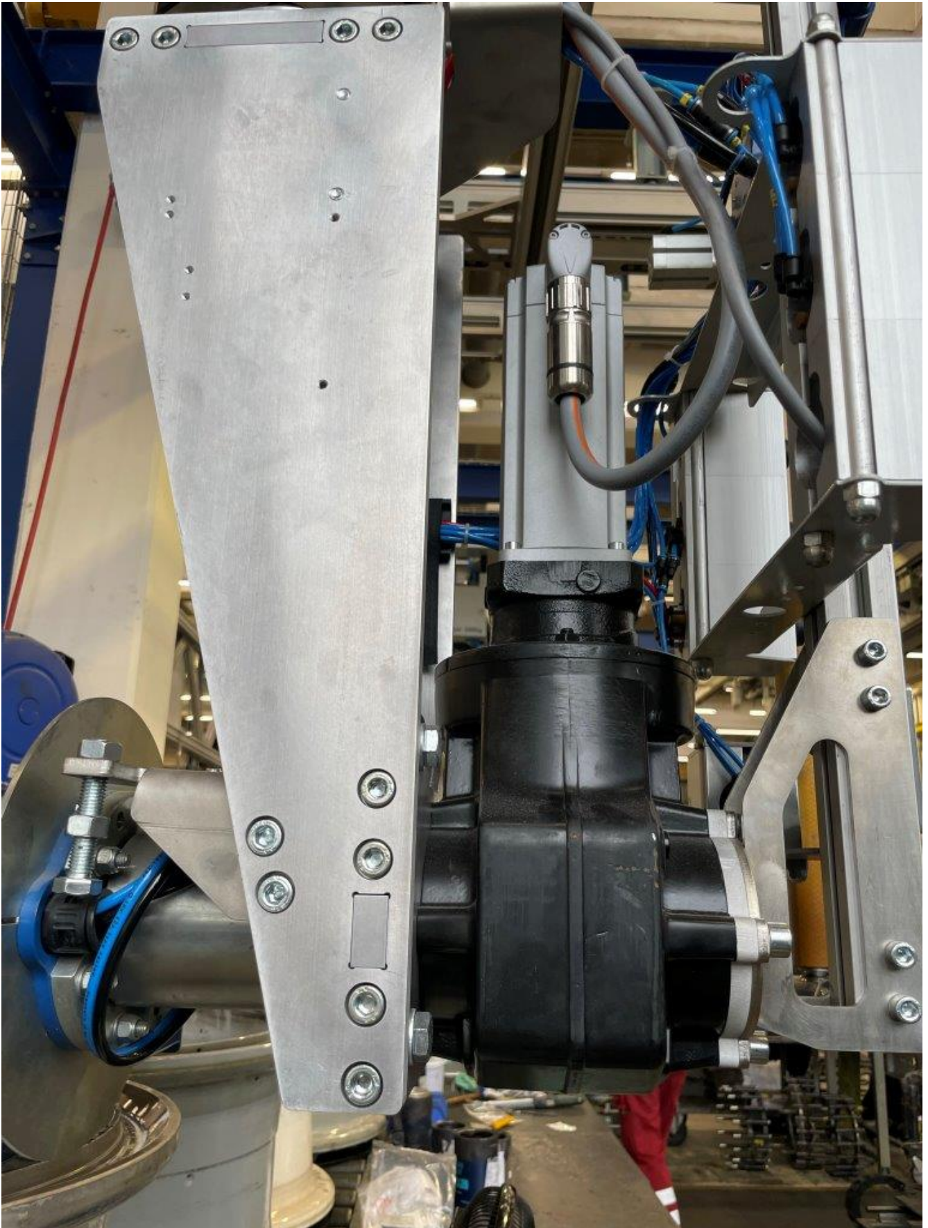
Die Lösung: Servos für die Drehung
